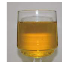
2 液の化学反応で硬化する KP2 は収縮せず周囲の温度の影響を受けません
